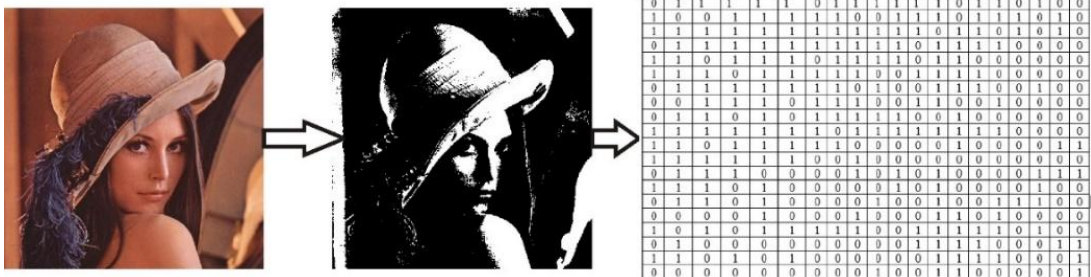
Hình 4. Quá trình biến đổi bức ảnh để truyền qua kênh vô tuyến
